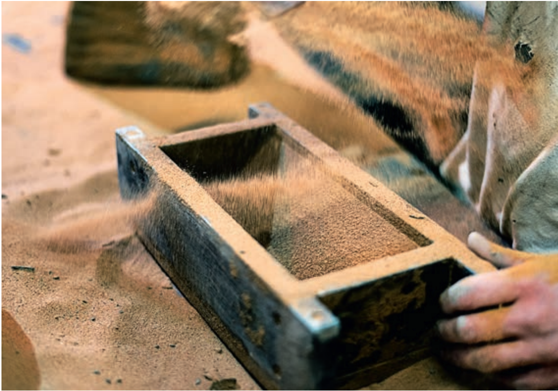
Подготовка формы для будущего кирпича
