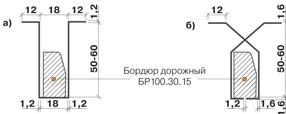
Рисунок 30. Специальные ручные приспособления для установки бортовых камней а) П-образное приспособление; б) Клещевое приспособление
